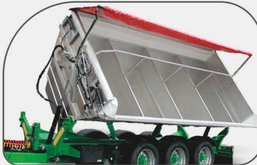
Doppelte Überwände mit pneumatischer Öffnung Auch in reversibler Version mit rechter/linker Aufwicklung
