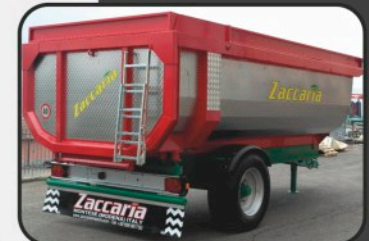
EINACHSIGER WANNENKIPPER ZAM 60/70 D (9/12 Kubikmeter, 60 t zulässig)
